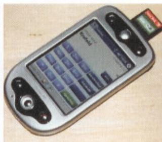
Die Sandisk-SD-WLAN-Karte bindet PDAs mit einem SDIO-Slot in WLAN-Infrastrukturen ein. Durch die zunehmende Verbreitung von Hotspots ist dies eine gute Alternative zu einer GPRS-Verbindung
