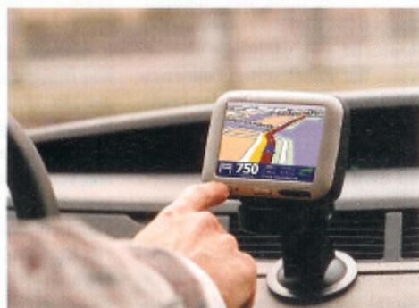
Der TomTom GO wird an einem flexiblen Arm befestigt und dieser dann per Saugnapf am Armaturenbrett oder an der Windschutzscheibe fixiert. Quelle: TomTom
