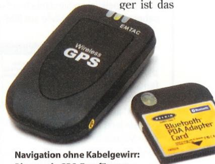
Navigation ohne Kabelgewirr: Bluetooth-GPS-Empfänger ([www.euric.de](http://www.euric.de)) und Bluetooth-CF-Adapter für PDAs ([www.belkin.de](http://www.belkin.de))
