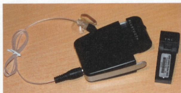
Die modulare Maus mit Bluetooth- und TMC-Modul (draußen), links die Wurfantenne für den Radioempfang
